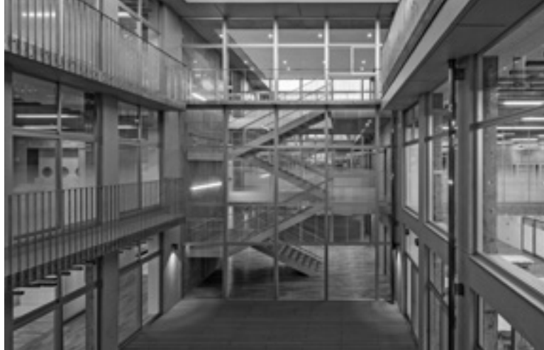
自然採光と自然換気を可能とする中庭
